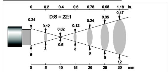
D:S 为光学分辨率表示形式，是指距测量点的距离除以测量点的直径所得的比率
